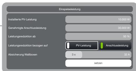
Beispiel: Einstellung einer 22 kW Wallbox auf 30 kW Hausmaximalleistung mit 10 kW PV-Anlage
